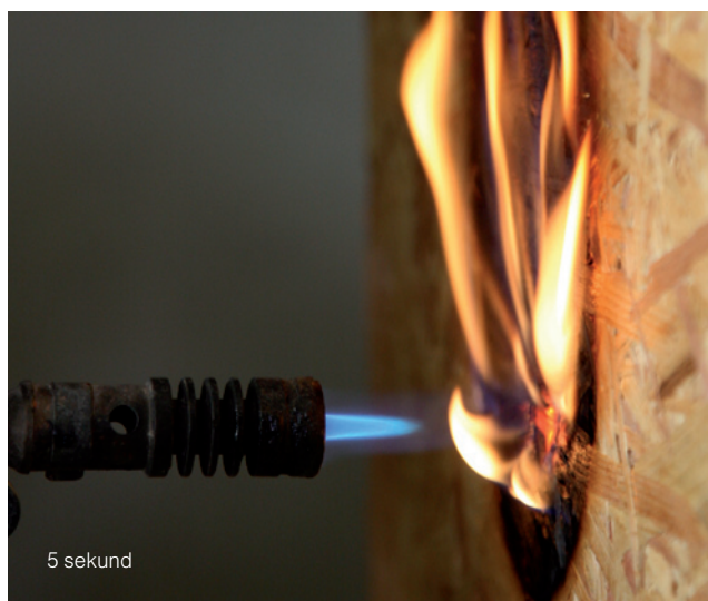
Zdjęcie nr 2 - Zastosowanie płyt OSB Firestop może wydłużyć czas rozwoju pożaru z kilku do kilkudziesięciu minut.
